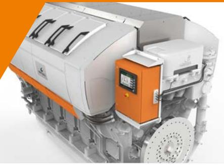
バルチラ31は、効率と総排出ガス性能のベンチマークになる為に設計された次世代の中速エンジンです。8~16シリンダー構成、回転数720rpmまたは750rpm、4.2MW~9.8MWの出力の、このクラスの最高燃費性能を有する4ストロークエンジンです。同時に、このエンジンは運転範囲全域にわたって優れた性能を発揮します。モジュール思想に基づく設計により、メンテナンス時間と費用を大幅に削減し、稼働率を改善、予備品を削減する事ができます。
